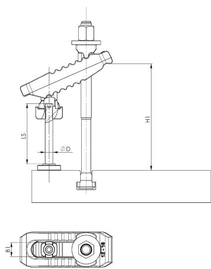
Einbauempfehlung und Abmaße bei Verwendung der Spannschraube
