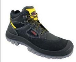
Sicherheitshochschuh Form B aus Vollrindleder, spezielle 2-Schichten PU-Laufsohle mit rutschsicherer ActiveGrip® Technologie, atmungsaktives Futter, leichte, nicht magnetische und selbstrückstellende Kunststoffkappe > 200 J Belastbarkeit, Stahlzwischensohle, Weite 11
