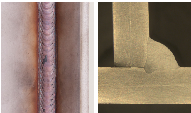
PF Steignaht, lineare Brennerführung ohne Tannenbaumtechnik
