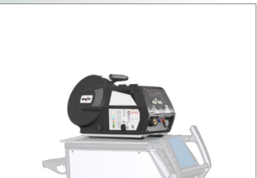
2. Drahtvorschub Geräteanschluss für Titan XQ kompakt
